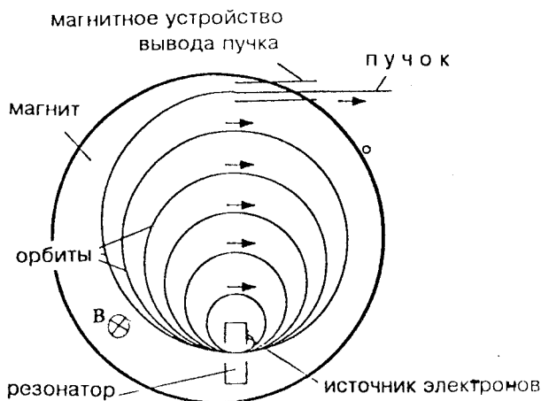
Рис.2. Принципиальная схема ускорения электронов в микротроне
