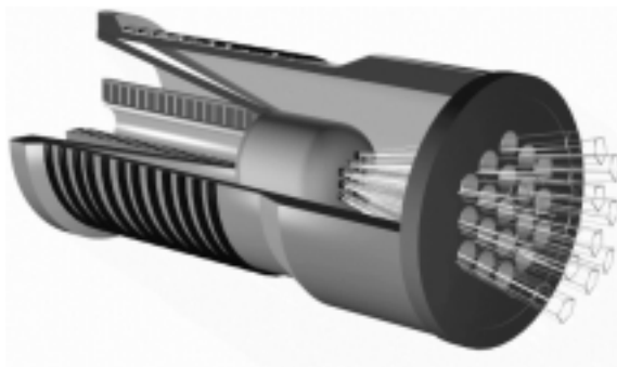
Рис. 8. Схема модели ускорителя на энергию 200 кэВ для радиационных технологий
