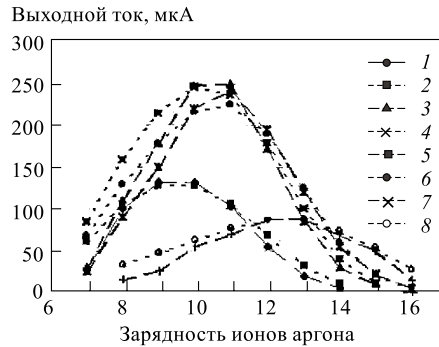
Рис. 11. Сопоставление экспериментальных (1, 3, 5, 7) и расчетных (2, 4, 6, 8) зарядовых распределений аргона. Чистый аргон: 1 — P = 1,09 кВт; 2 — N_e = 1,0 \cdot 10^{12} см -3 , T_e = 6 кэВ, P = 1,0 кВт. Аргон: кислород: 3 — оптимизация для Ar^{11+} , P = 0,47 кВт; 4 — 6:1 по нейтралам, N_e = 1,7 \cdot 10^{12} см -3 , T_e = 7 кэВ, P = 1,7 кВт; 5 — оптимизация для Ar^{12+} , P = 1,2 кВт; 6 — 6:1 по нейтралам, N_e = 1,8 \cdot 10^{12} см -3 , T_e = 8 кэВ, P = 1,9 кВт; 7 — оптимизация для Ar^{15+} , P = 1,4 кВт; 8 — 3:2 по нейтралам, N_e = 2,0 \cdot 10^{12} см -3 , T_e = 13 кэВ, P = 1,8 кВт
