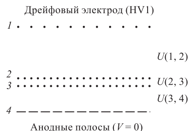
Рис. 1. Схематическое изображение многопроволочного газового электронного умножителя: 1 — верхний электрод системы; 2, 3 — многопроволочные электроды ГЭУ; 4 — полосковый анод. Электроды 1 и 2 образуют ионизационный и первый дрейфовый промежутки. Второй дрейфовый промежуток образован электродом 3 и собирающим анодом 4. Умножение первичной ионизации происходит в электрическом поле между электродами 2 и 3. U(1, 2) , U(2, 3) и U(3, 4) — разности потенциалов соответствующих промежутков
