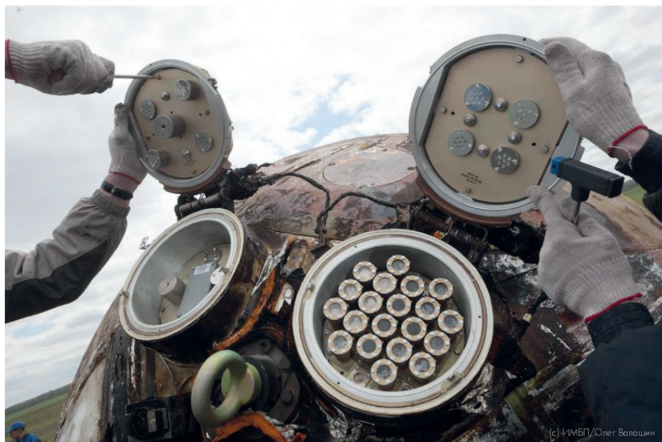
Рис. 39. Возвращение космического аппарата БИОН-М1 на Землю. На фото показаны отсеки с образцами, которые открываются во время полета на орбите спутника. Научный проект «Биоспутник» (фото О. Волошина, ИМБП РАН).
