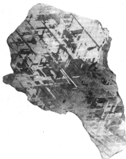
Рис. 42. Железный метеорит Arispe (полированная поверхность). Видно прорастание двух железоникелевых сплавов с различной кристаллической структурой и различным содержанием Ni (Додд, 1986).
