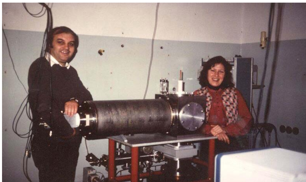
В сотрудничестве с CSNSM (Орсе) создан электростатический бета-спектрометр с рекордным энергетическим разрешением \Delta E \simeq 4 эВ в области 1–20 кэВ
