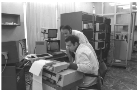
Средний уровень трехуровневой системы регистрации, обработки и анализа спектрометрической информации
