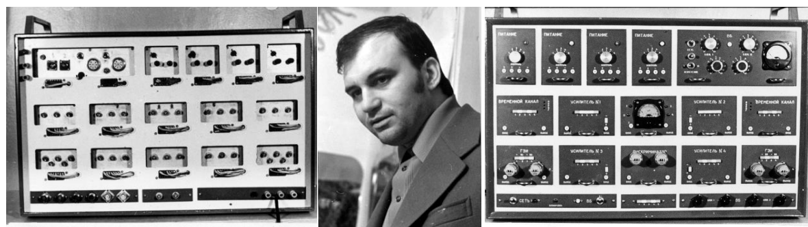
Комплекс спектрометров для прецизионного исследования спектров \alpha -, \beta -, \gamma - и X -излучения на основе полупроводниковых детекторов
