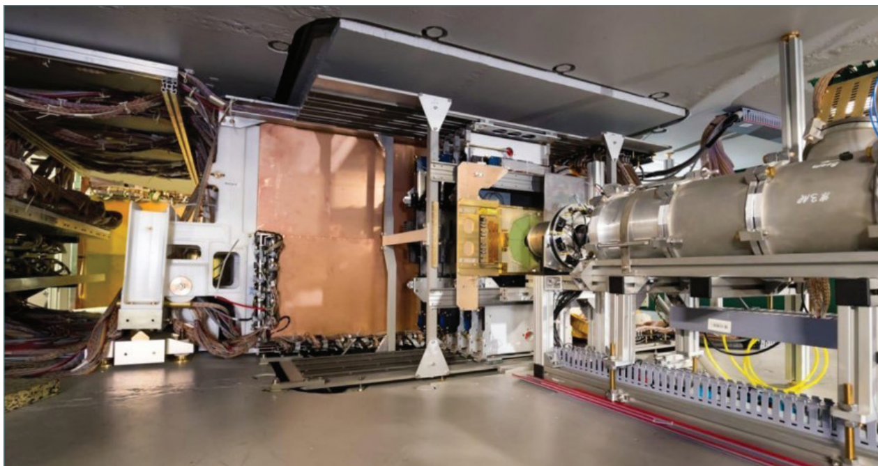
Триггерные детекторы мишенной зоны и центральная трековая система внутри спектрометрического магнита BM@N
