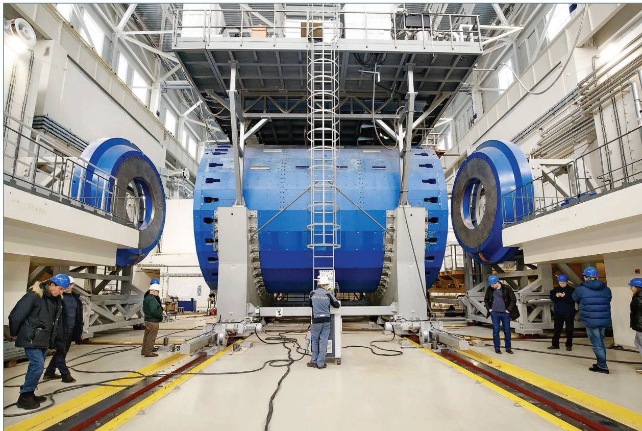
Технологическое перемещение 800-тонного соленоида детектора MPD
