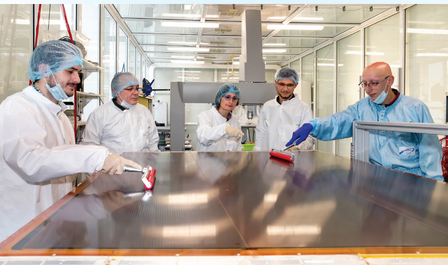
Подготовка считывающей панели перед сборкой детектора MicroMegas для эксперимента ATLAS
