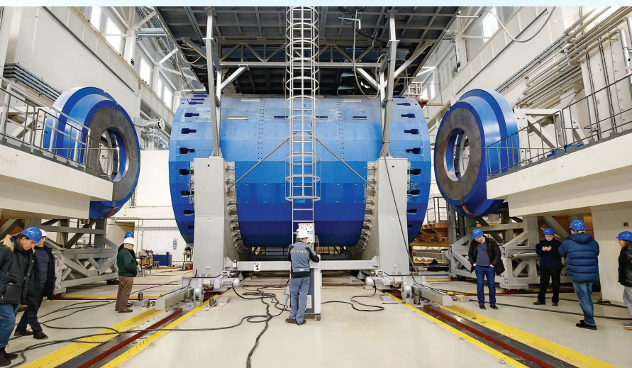
Технологическое перемещение 800-тонного соленоида детектора MPD
