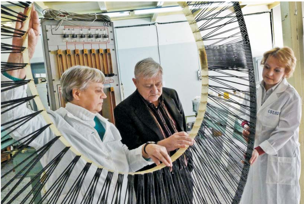
Лаборатория физики высоких энергий им. В. И. Векслера и А. М. Балдина. Полномасштабный прототип шестислойного элемента ЕС-детектора NICA
