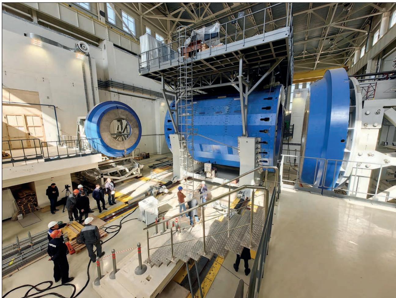
Лаборатория физики высоких энергий им. В. И. Векслера и А. М. Балдина, 14 апреля. Перемещение сверхпроводящего соленоида многоцелевого детектора MPD ускорительного комплекса NICA массой 800 т в текущую конфигурацию
