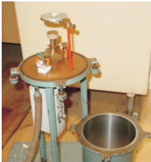
Рис. 6. Камера для измерения эффективности сепаратора (зарядочувствительный предусилитель пристыкован к вакуумному разьему). Показан тестовый детектор ( p\text{-Si(Au)} ) для проверки электронного тракта и измерения энергии пучка циклотрона
