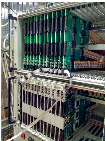
Рис. 95. Мезонинная плата, установленная на модуль «ЕвроМИСС», и переходные платы
