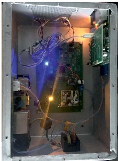
Рис. 96. Модуль мониторинга параметров магнита мишени «Динозавр»
