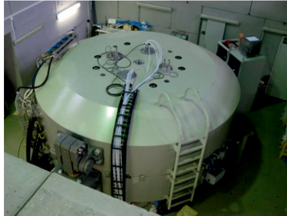
Рис. 16. Пучковые испытания циклотрона ОИЯИ-ИВА С235-V3 в инженерном центре ОИЯИ
