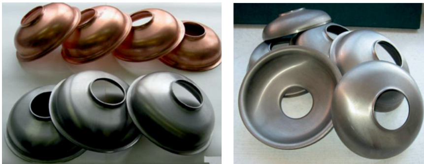
Рис. 5. Полуячейки из меди и алюминия (слева) и из ниобия (справа), изготовленные методом гидроударной штамповки на прессе СФТ-510
