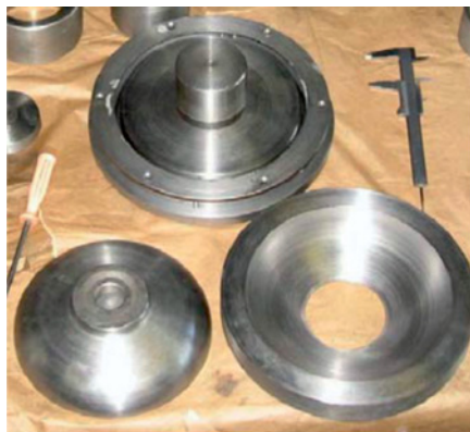
Рис. 6. Детали устройства механической обработки полуячеек
