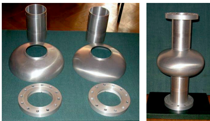
Рис. 7. Изготовленные детали одноячеечного резонатора (слева) и резонатор в сборе (справа)
