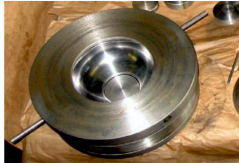
Рис. 4. Оснастка для гидроударной штамповки полуячеек резонатора
