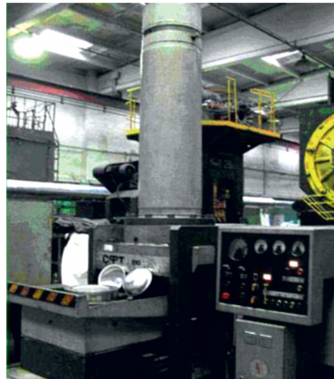
Рис. 1. Гидроударный пресс СФТ-510
