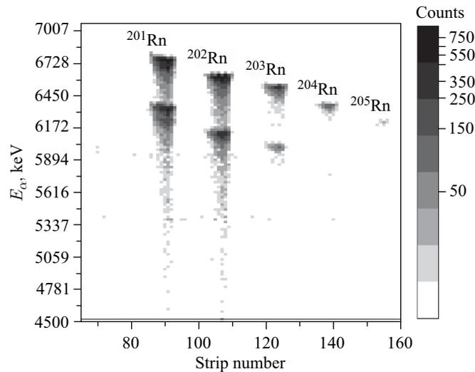
Fig. 5.  $^{40}\text{Ar} + ^{166}\text{Er} \rightarrow ^{206-x}\text{Rn} + x\text{n}$  heat map
