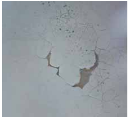
Рис. 3. Поверхность фторполимерного покрытия сразу после осаждения на поверхность титановой камеры при азотной температуре
