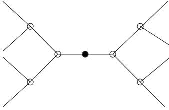
Рис. 1. Самоподобная фрагментация одного объекта (●) на  $b$  частей согласно  $b$ -адическому дереву. Показан случай  $b = 2$
