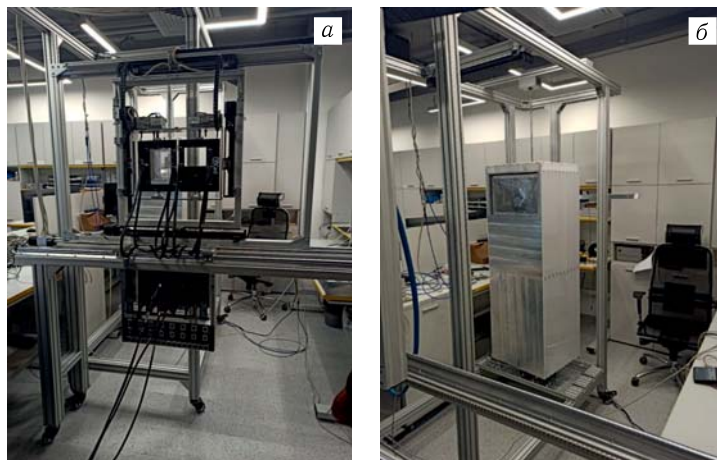
Рис. 2. Система позиционирования (а) и ослабитель энергии (б) станции ИСКРА
