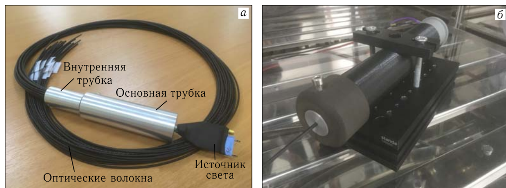
Рис. 5. а) Вид оптического разветвителя в сборе с источником света; б) вид измерительного стенда
