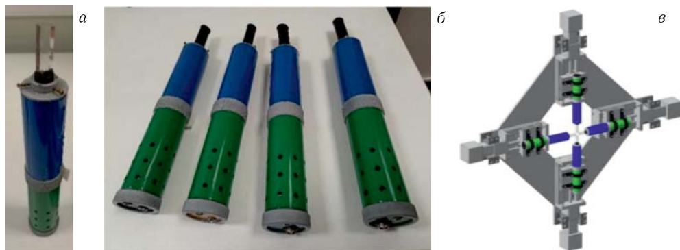
Рис. 4. ОД СИМБО: сцинтилляционные детекторы (а, б) и модель ОД (в)
