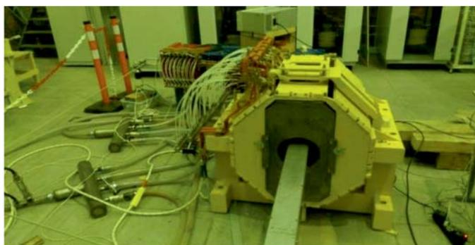
Рис. 4. Система магнитных измерений в поворотном магните
