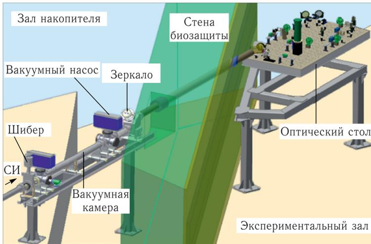
Рис. 4. 3D-модель диагностической станции. Виден вакуумный канал вывода СИ из поворотного магнита
