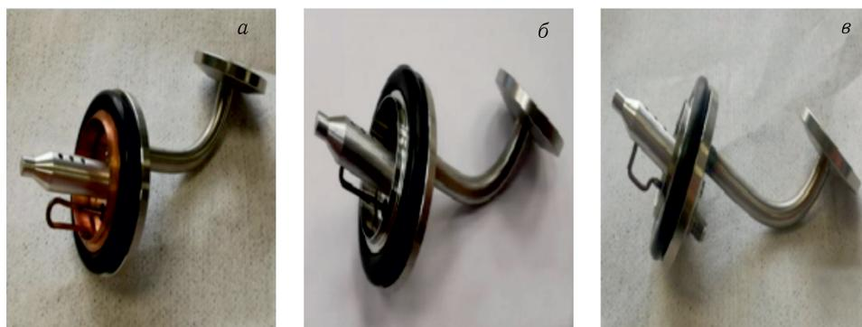
Рис. 5. Сменные части резонатора (ввод мощности)
