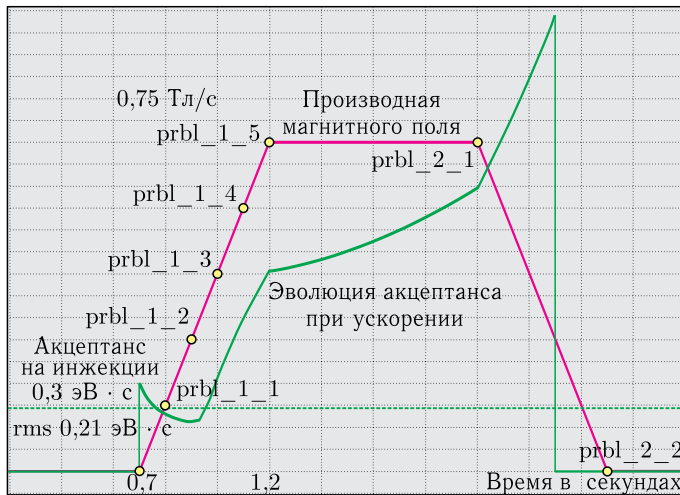
Рис. 5. Зависимость продольного акцептанса и производной магнитного поля от времени для цикла ускорения в четвертом сеансе
