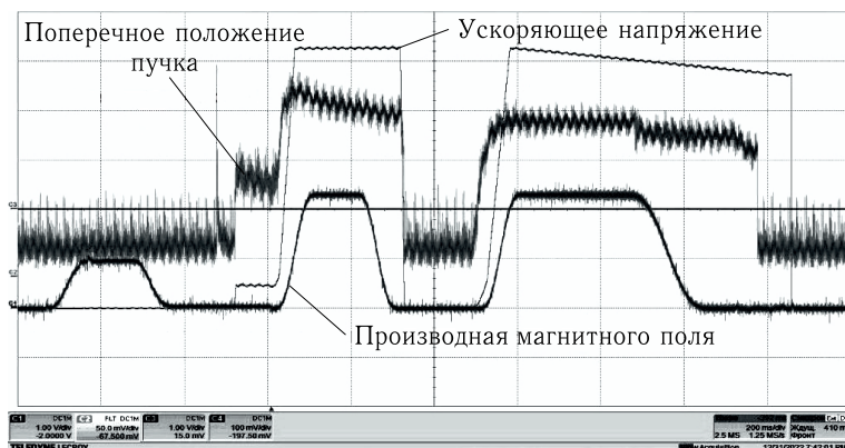
Рис. 1. Зависимости от времени ускоряющего напряжения, производной магнитного поля и показаний датчика поперечного положения пучка. Цена деления по оси времени — 200 мс, по вертикали — 1 В
