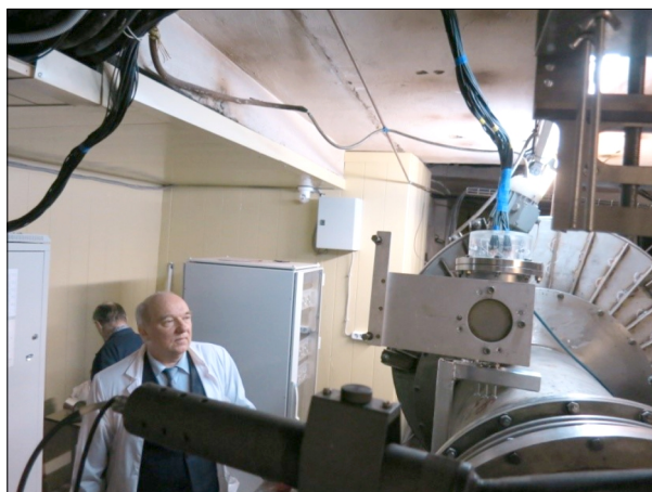
Рис. 2. Мишенная и детекторная станция с дистанционным управлением положением детекторов
