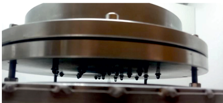
Рис. 1. Гравитационная капельница для изготовления замороженных шариков из смеси мезитилена и метаксилола
