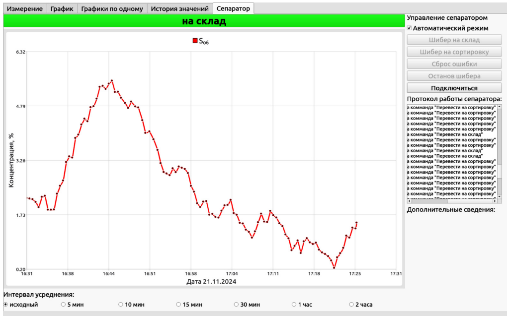
Рис. 6. Интерфейс оператора. Центральная панель показывает массовую концентрацию серы, боковая панель — статус команды, отправленной на узел сепарации
