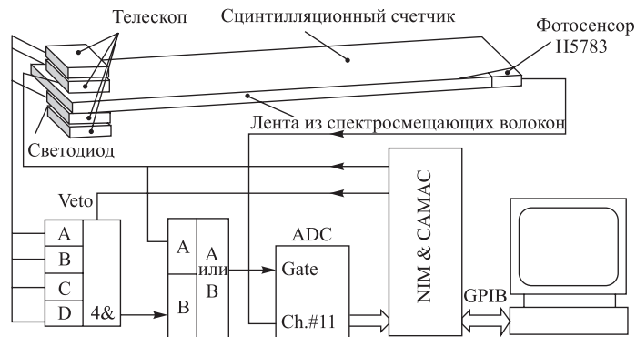
Рис. 4. Блок-схема установки для исследования основных параметров прототипов счетчиков SSU
