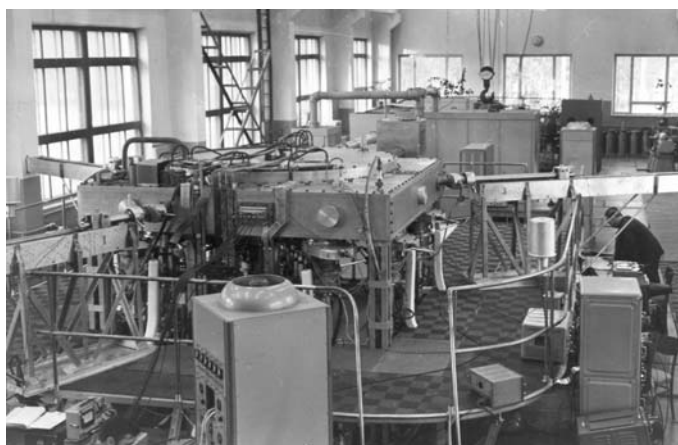
Рис. 2. Подготовка к измерениям коррекции фазы по пучку на ЭМКЦ
