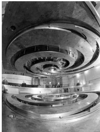
Рис. 4. Спиральные шиммы на полюсах магнита фазотрона
