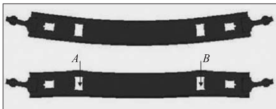
Рис. 2. Формы деформации поперечной балки спейсера для случая, когда она опирается только на концевые опоры-шары (вверху). То же при максимальной компенсации прогиба с поддержкой на технологической балке в точках A и B (внизу). Величина деформации в последнем случае увеличена для наглядности, в действительности она значительно меньше, чем в первом случае. Расчеты выполнены методом конечных элементов с использованием программы ANSYS
