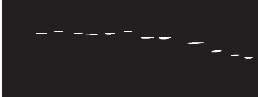
Рис. 3. Растровая структура волнового фронта на выходе ортогонализатора изображений при освещении его пучком света от лазера
