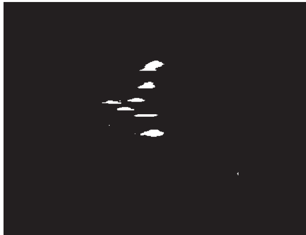
Рис. 4. Микроструктура сигнала, сфокусированного цилиндрической линзой, в пределах пика
