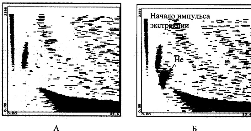
Рис.3. Калибровка ВПМА гелием: А – без калибровочного газа, Б – с калибровочным газом. Ось X – время пролета ионов 0 \div 25.6 мкс, Y – амплитуда импульса напряжения, приложенного к вертикальной пластине экстрактора, 0 \div 2300 В. Амплитуда выталкивающего импульса напряжения, приложенного к горизонтальной пластине экстрактора, постоянна и равна 2584 В. Ток электронного пучка 200 мА, энергия электронов 5 кВ.
