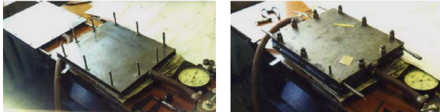
Рис. 4. СКЛУСТ 460×350 мм: а) в раскрытом состоянии; б) во время склейки
