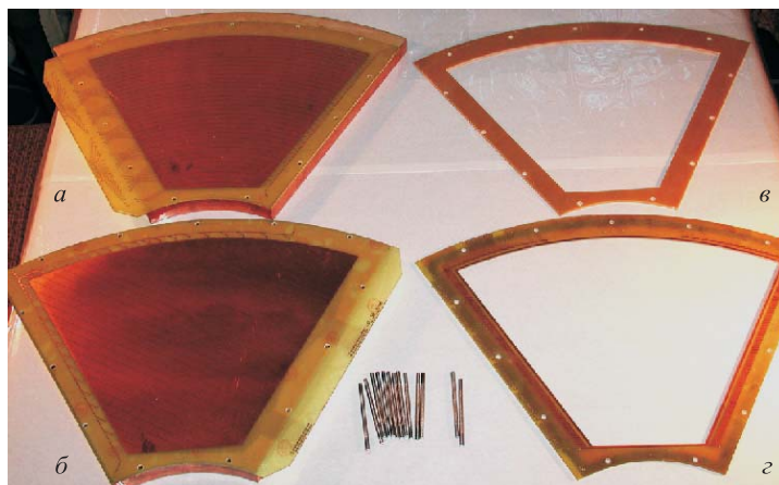
Рис. 5. Части МППК, изготовленные на СКЛУСТ 460×350 мм: а) и б) катодные плоскости со стрипами; в) разделительная рама; г) анодная рама
