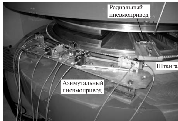
Рис. 15. Размещение системы магнитных измерений в рабочей области электромагнита
