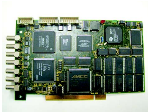
Рис. 4. Блок накопления данных (PCI DAQ)
