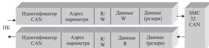
Рис. 3. Протокол обмена ПК и контроллера SMC-32-CAN
