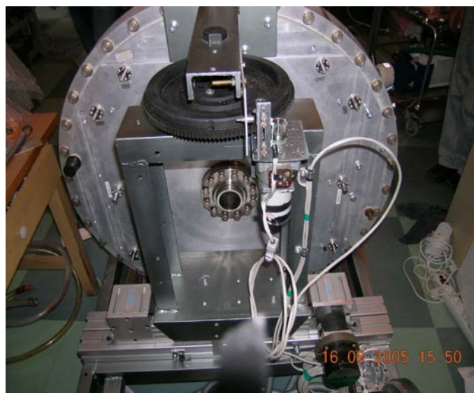
Рис. 7. Детектор спектрометра ЮМО: линейное перемещение на 10 м, горизонтальная и вертикальная юстировка
