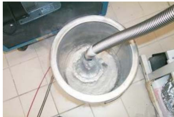
Fig. 28. Helicoflex test inside a Dewar
