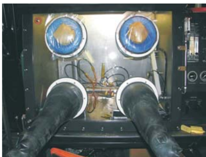
Fig. 5. Fermilab's titanium welding «glove box»
