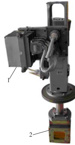
Рис. 2. Двухкоординатная диагностическая камера: 1 — предусилители; 2 — МПК
