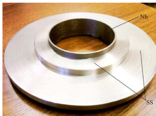
Рис. 15. Образец переходника Nb + SS, полученный методом внутренней плакировки
