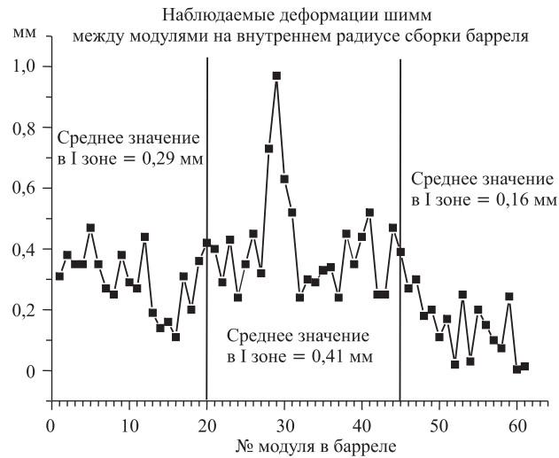
Рис. 24. Зависимость величин деформаций шимм от их расположения в собранном барреле
