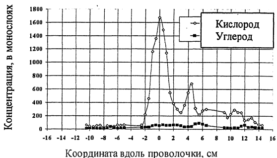
Рис.20б. Распределения концентрации кислорода и углерода вдоль проволочки, полученные методом NRA.
