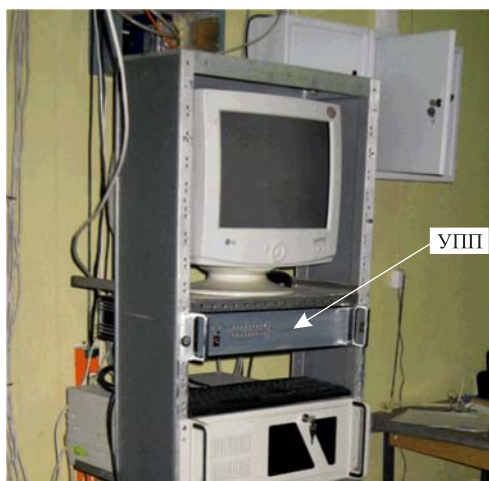
Рис. 8. Устройство позиционирования пробников (УПП) в стойке диагностики
