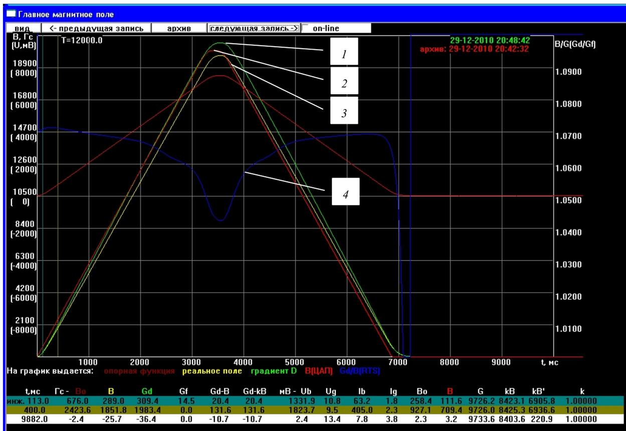
Рис. 1.7. Диаграмма цикла с полем дипольных магнитов на столе 2 Тл. Кривая 2 — опорная функция, кривые 3 и 1 — измеренные значения поля магнитов и градиента квадрупольных линз соответственно. Кривая 4 — отношение градиента линз к полю дипольных магнитов ( $G/B$ ). 42-й сеанс
