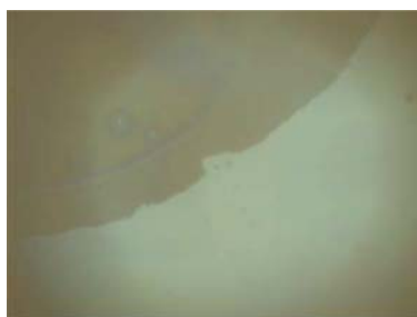
Рис. 10. Изображение следа от маркера на кремниевой пластине с видеокамеры микроскопа (объектив \times 60 ). Вверху слева — след маркера, внизу справа — чистый кремний
