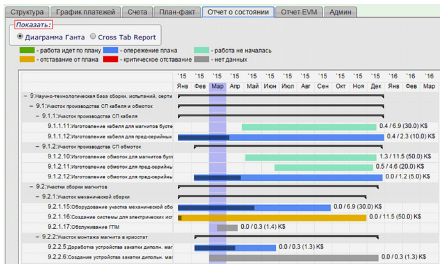
Рис. 9. Пример web-интерфейса отображения диаграммы Ганта с отслеживанием хода выполнения работ
