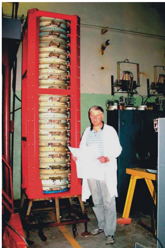
Рис. 9. Общий вид соленоида при контрольной сборке
