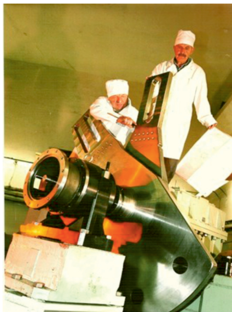
Рис. 8. Подвижный отражатель реактора ИБР-2
