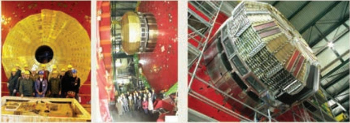
Мегатайлы устанавливались в пазы латунной матрицы. Спектрсмещающие волокна подключались к считывающему устройству.
