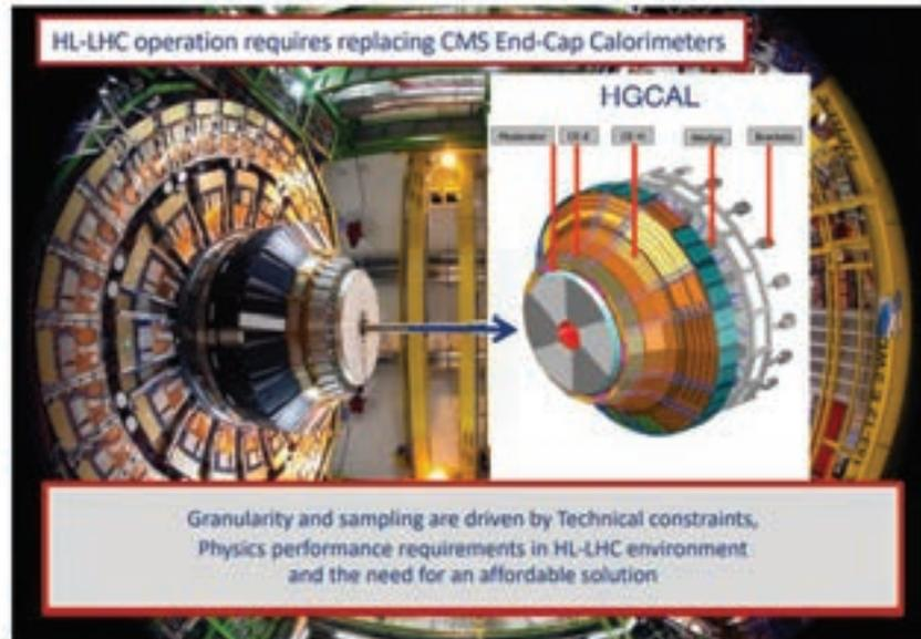
Предлагается создать адронный калориметр высокой гранулярности. Ближняя к пучку часть состоит из кремниевых детекторов (они обеспечивают необходимый уровень радиационной стойкости), внешняя часть изготавливается из более дешевых сцинтилляторов с SiPM.
