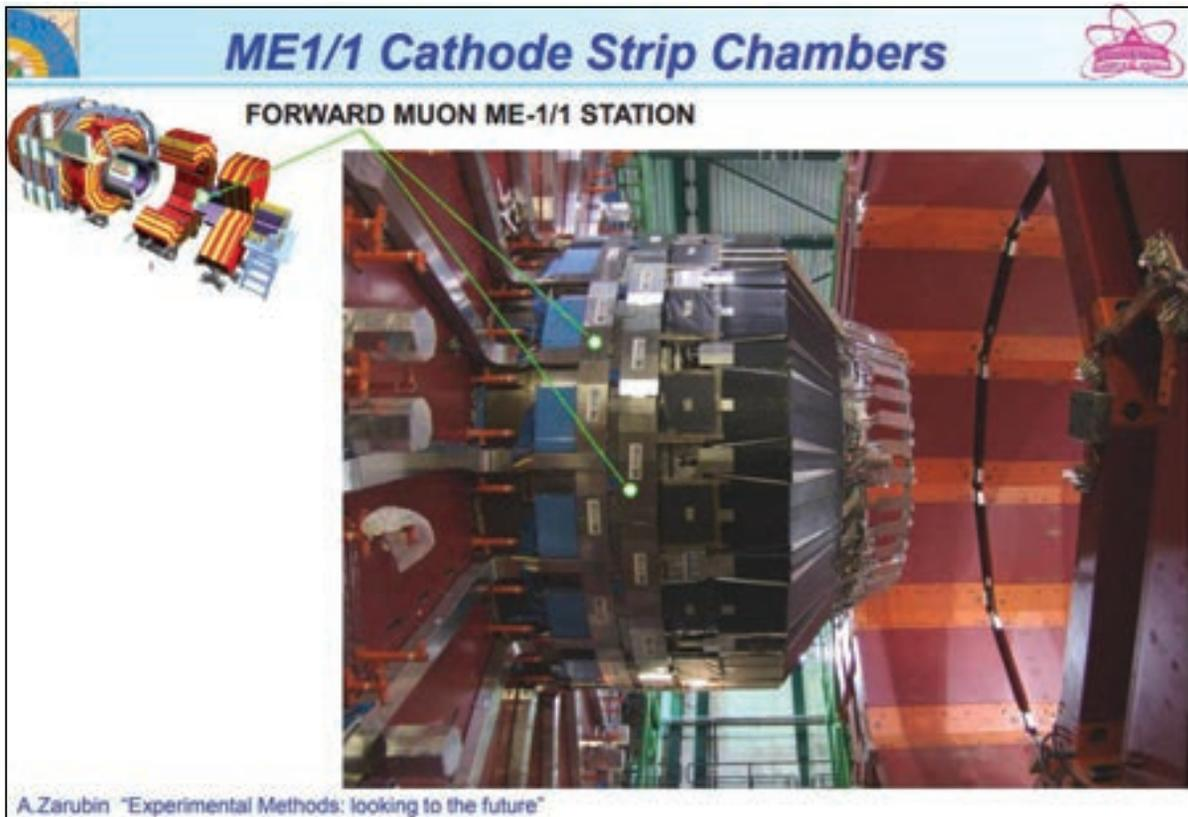
Передняя мюонная станция установки CMS с катодными стриповыми камерами.
