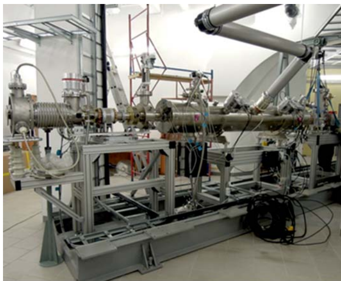
Начальная часть линейного ускорителя тяжелых ионов коллайдерного комплекса NICA
