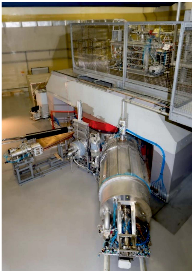
Базовая установка фабрики СТЭ — циклотрон ДЦ-280
