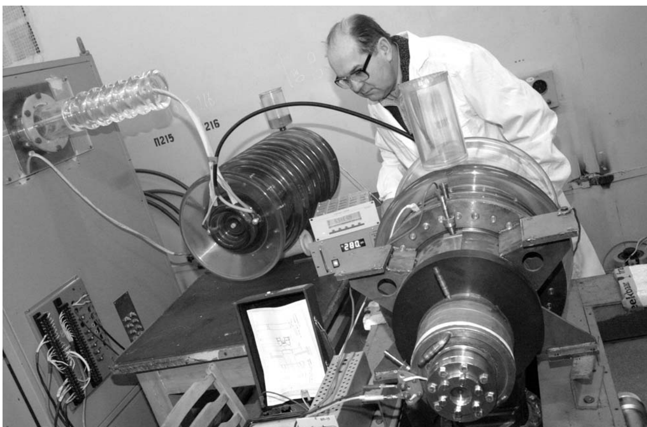
Лаборатория нейтронной физики им. И. М. Франка. Стендовые испытания источника электронов для установки ИРЕН
