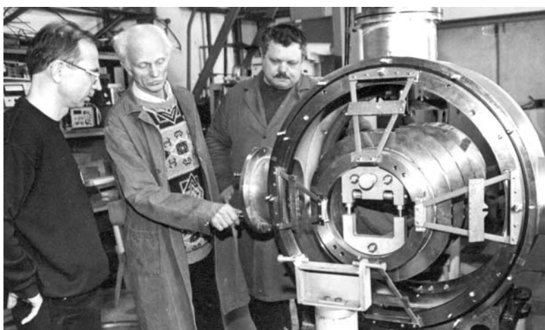
Лаборатория высоких энергий им. В. И. Векслера и А. М. Балдина. Новый сверхпроводящий источник ионов с электронно-циклотронным резонансом, разработанный для ускорителя ИЦ-100 ЛЯР им. Г. Н. Флерова
