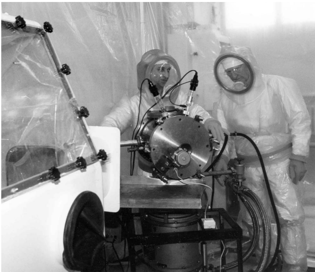
Лаборатория ядерных реакций им. Г. Н. Флерова. Блок уникальной ^{249}\text{Ca} -мишени, используемый в экспериментах по синтезу новых элементов Периодической системы
