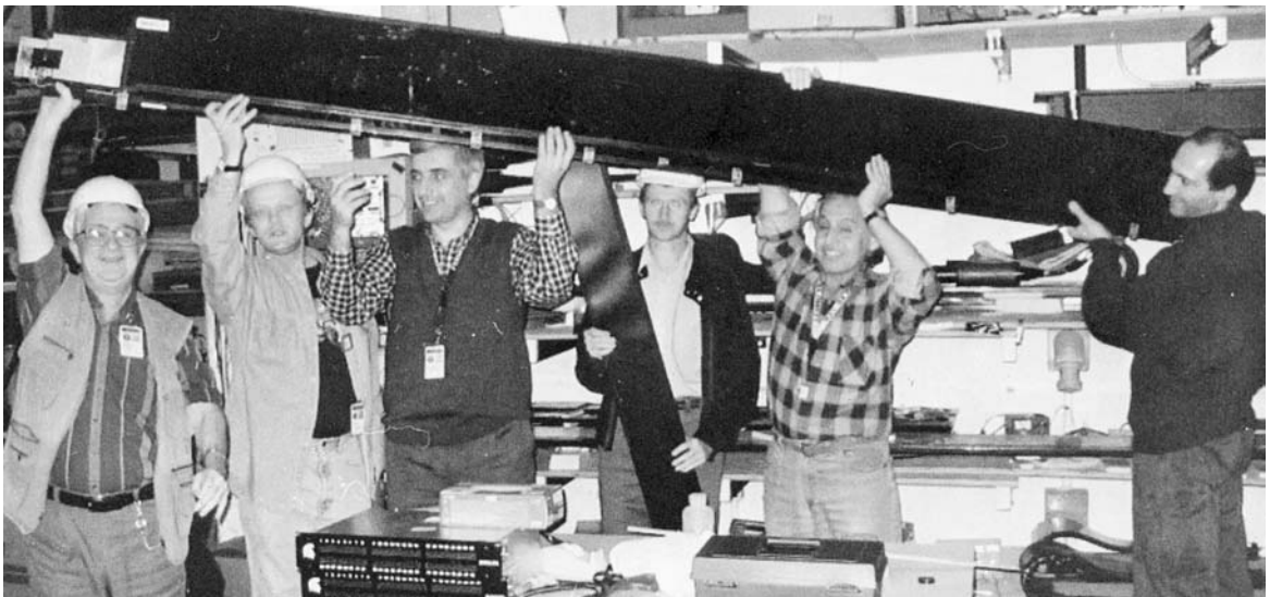
Батавия (США), декабрь. Группа специалистов ОИЯИ ведет монтаж сцинтилляционных детекторов, созданных в Дубне, для эксперимента CDF (FNAL)
